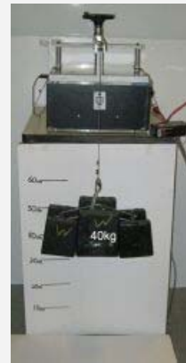
用電流變液製造的離合器可負載40公斤的重物
